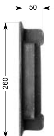
27 463 1,16 kg Anschlagtiefe 24 mm für Rahmenbreite 30 mm Keeper 24 mm for frames 30 mm Gache 24 mm pour cadre 30 mm
