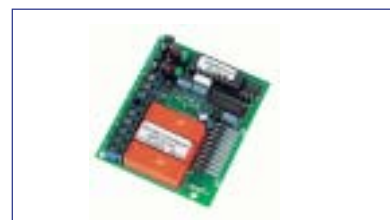
99 756 Einbahnstraßensteuerung Single lane street control system für alle ACM-Motorsteuerungen
