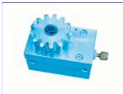
99 326 Radialdämpfer Radial muffler Modul 4 für steigende Schiebetore ideale Geschwindigkeitsregulierung für Tore mit Steigung; einseitig wirkende Dämpfung kann stufenlos eingestellt werden; Gegendreh- richtung mit Freilauf versehen. Steigung darf 5 % nicht übersteigen
